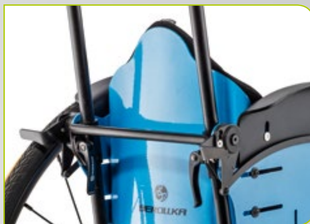
Einzelne Schiebegriffe höhenverstellbar und abnehmbar single push handles height adjustable and removable
